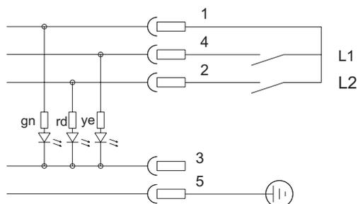
Posición de contacto con depósito vacío
